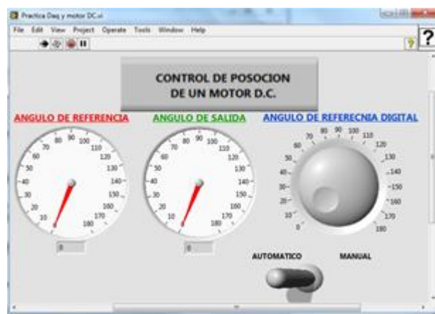
Figura 44. Ejecución del VI a 0 grados
