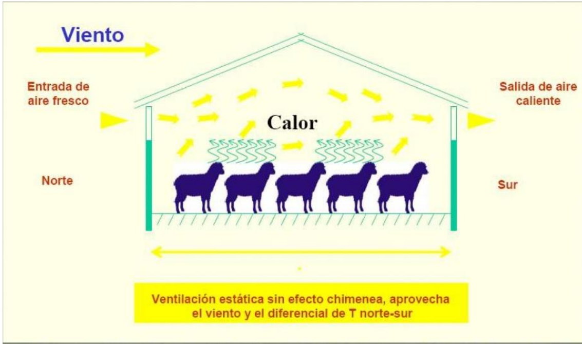
Figura 9. Ventilación estática sin efecto chimenea, aprovecha el viento y el diferencial de T norte-sur
