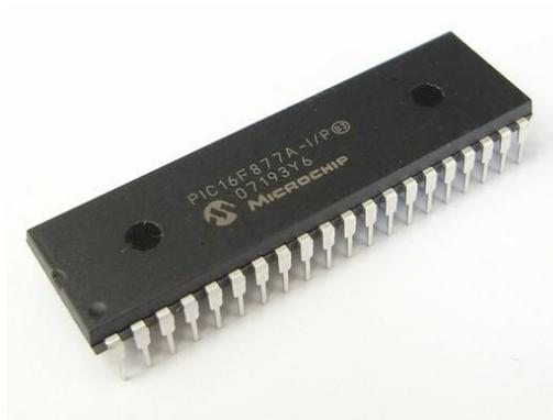
Figura 3. Micro controlador 16F877A, <http://microcontrollerslab.com/>
