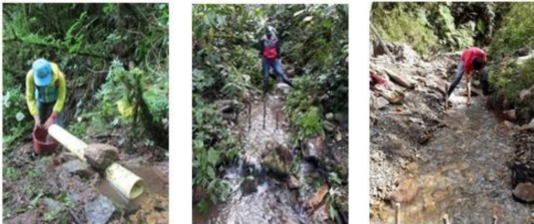
Figura 32 Medición de caudal parte alta, media y baja de la quebrada El Cedro
