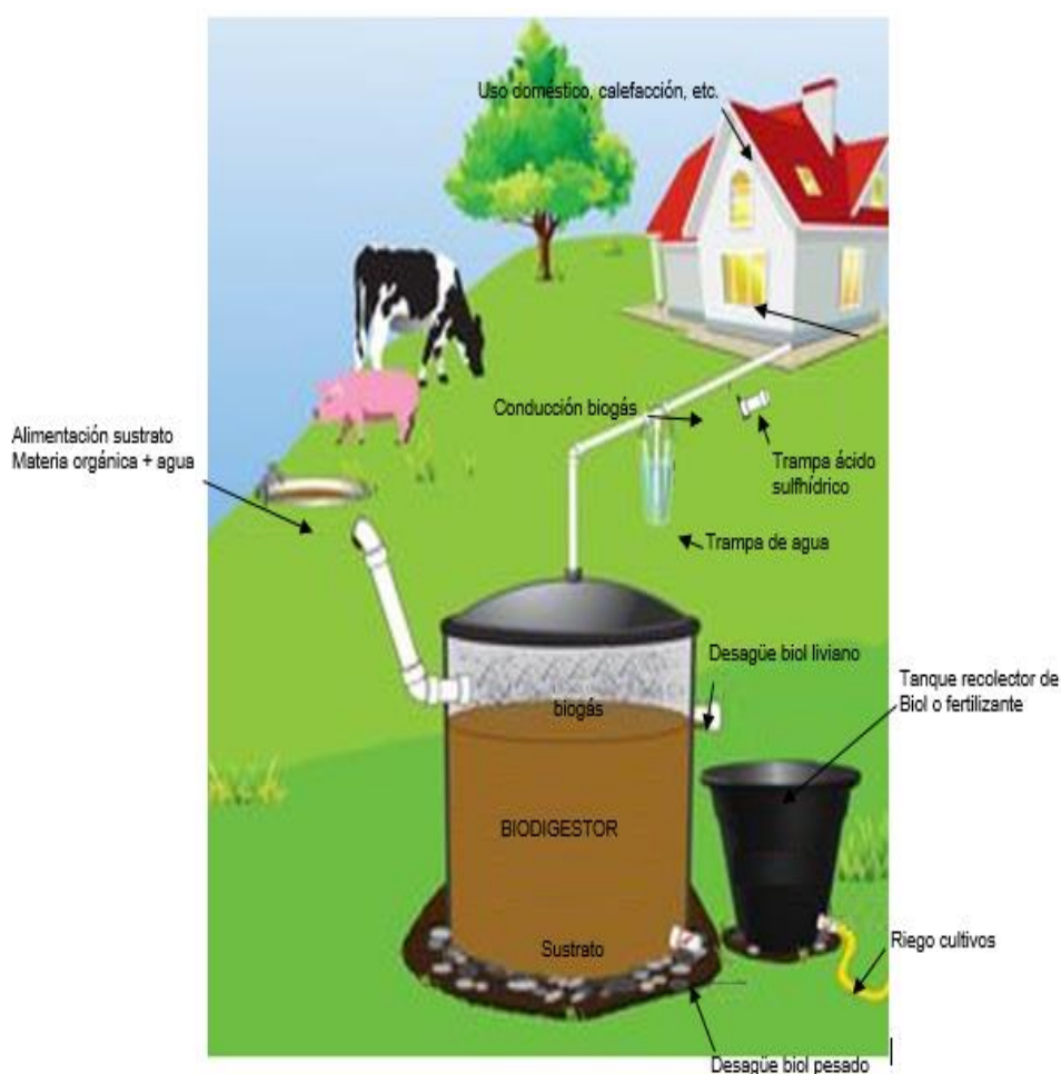
Figura 3. Proceso de Producción de biogás. Basado en http://www.rotoplast.com.co/biodigestor/ (s.f.)
