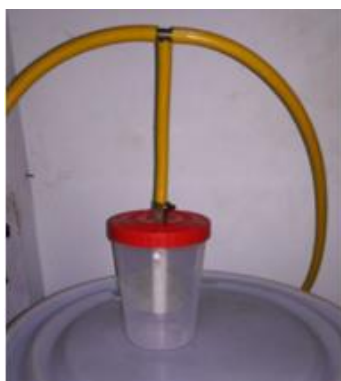
Figura 36. Instalación trampa de agua. "Elaboración propia".
