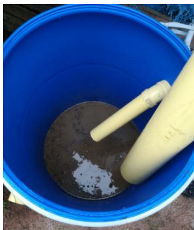
Figura 39. Llenado biodigestor con el sustrato. "Elaboración propia".
