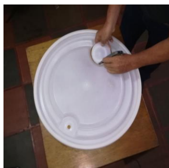
Figura 30. Apertura de los agujeros, tapa tanque plástico. “Elaboración propia”.
