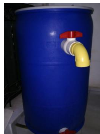
Figura 34. Instalación desagües biodigestor. "Elaboración propia".
