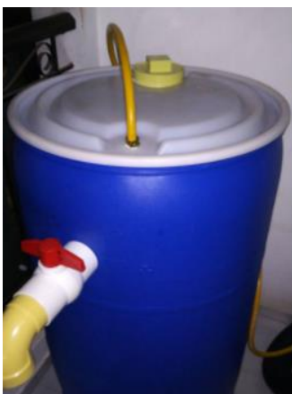
Figura 35. Instalación manguera de alta presión para gas. "Elaboración propia".
