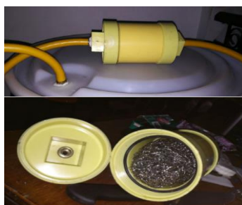
Figura 37. Instalación trampa ácido sulfhídrico. "Elaboración propia".
