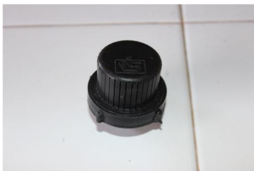
Figura 11: boquillas recolectoras de agua filtrada
