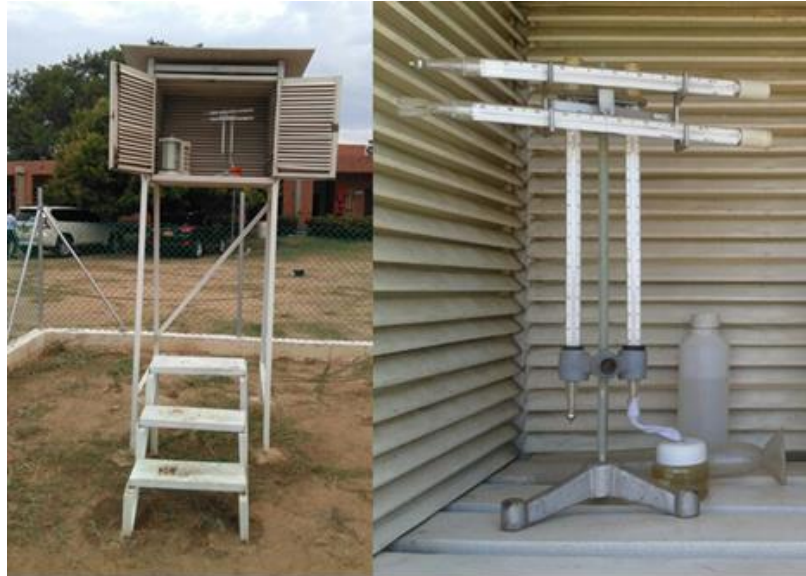
Figura 3 Caseta Psicométrica Fuente: Autores 2018
