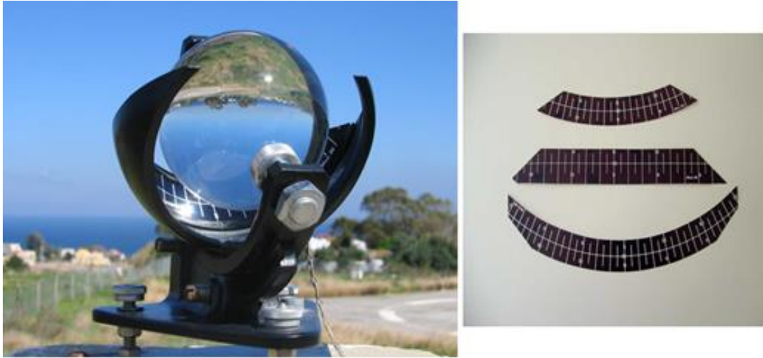
Figura 5 Heliógrafo Fuente: Autores 2018
