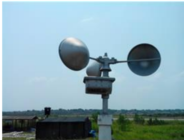
Figura 2 Anemómetro Fuente: Autores 2018
