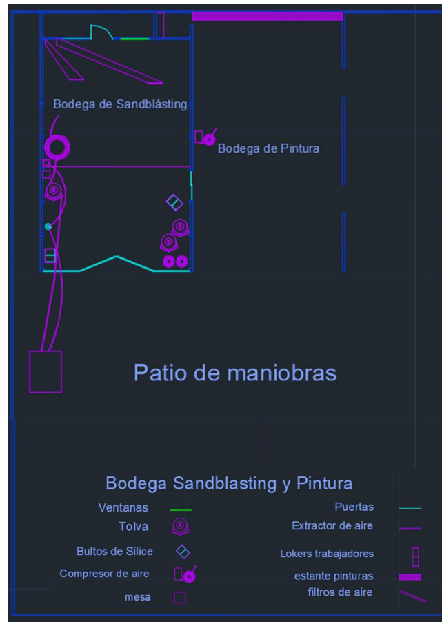
Imagen 2. Distribución en planta del proceso de Sandblásting y pintura de SEMITEC S.A.S.
