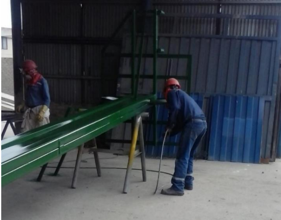
Imagen 8. Aplicación de pintura esmalte uretano serie 36 en la bodega de Pintura de SEMITEC S.A.S.
