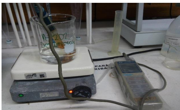
Ilustración 2 medición de ORP de la muestra
