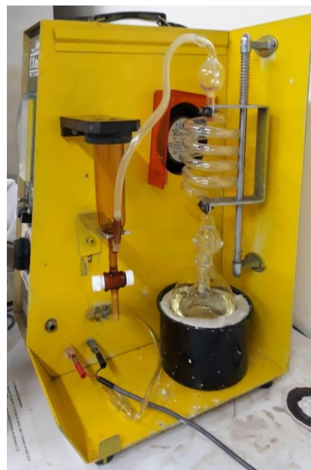
Figura 7. Cianurometro -Proceso de Dilución de los Residuos Cianurados.
