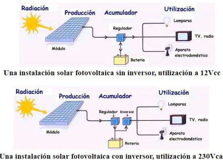
Figura 1. Componentes de un sistema fotovoltaico
