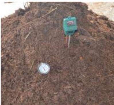
*Figura 11 Medición de acidez y temperatura*
