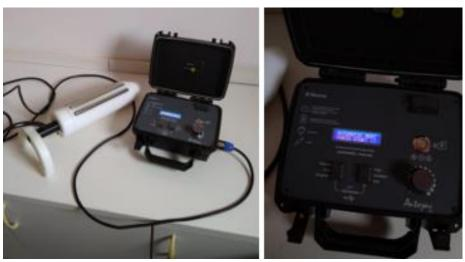
*Ilustración 28* Electro eyaculador (transductor y unidad para control de voltaje)
