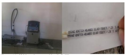
*Ilustración 32* Marcador automático de Pajillas
