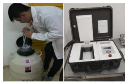
Ilustración 31 Termo de Nitrógeno y Congeladora Automática de Semen
