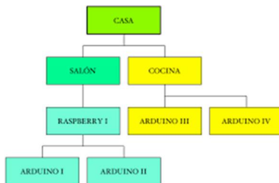
Figura 22. Estructura de los topic. Copyright 2017 por Introducción a IoT usando protocolo mqtt.
