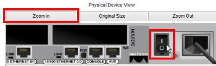
Figura 143 Apagado router 2621XM
