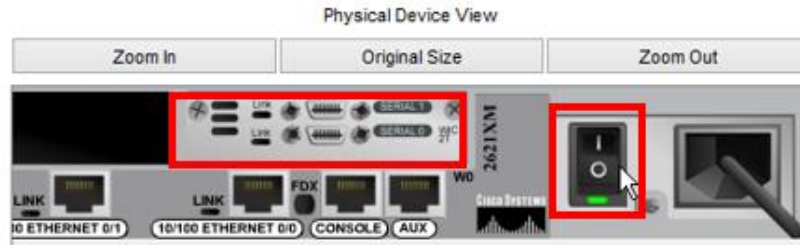
Figura 145 Encendido de router 2621XM con módulo WIC-2T colocado
