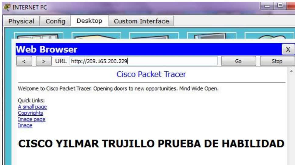
Figura 37. Verificación de conectividad entre Internet PC y Web Server
