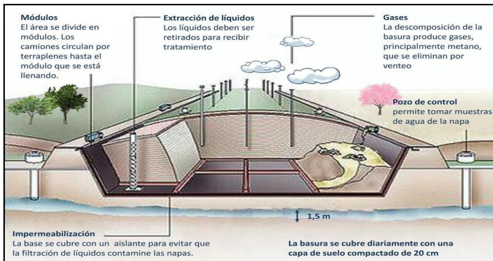
Figura 8. Como funciona un relleno sanitario.
