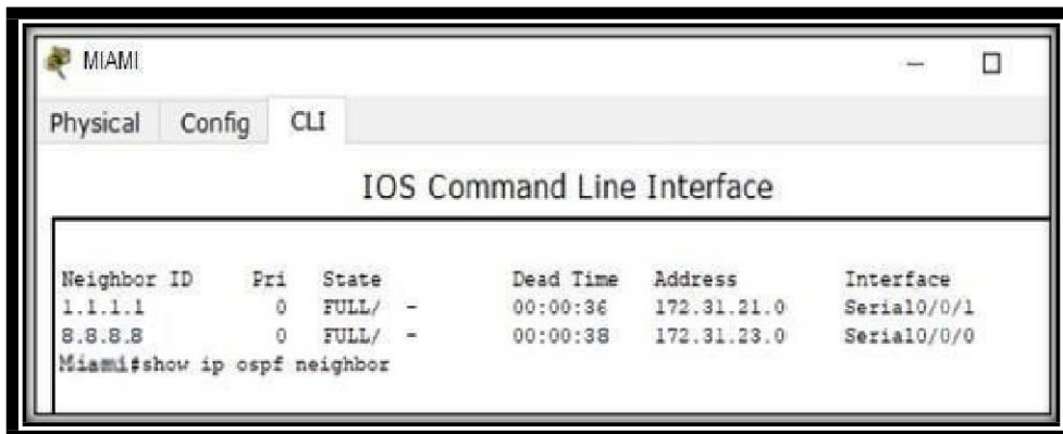
Figura 20 Verificación Miami conectado por OSPFv2
