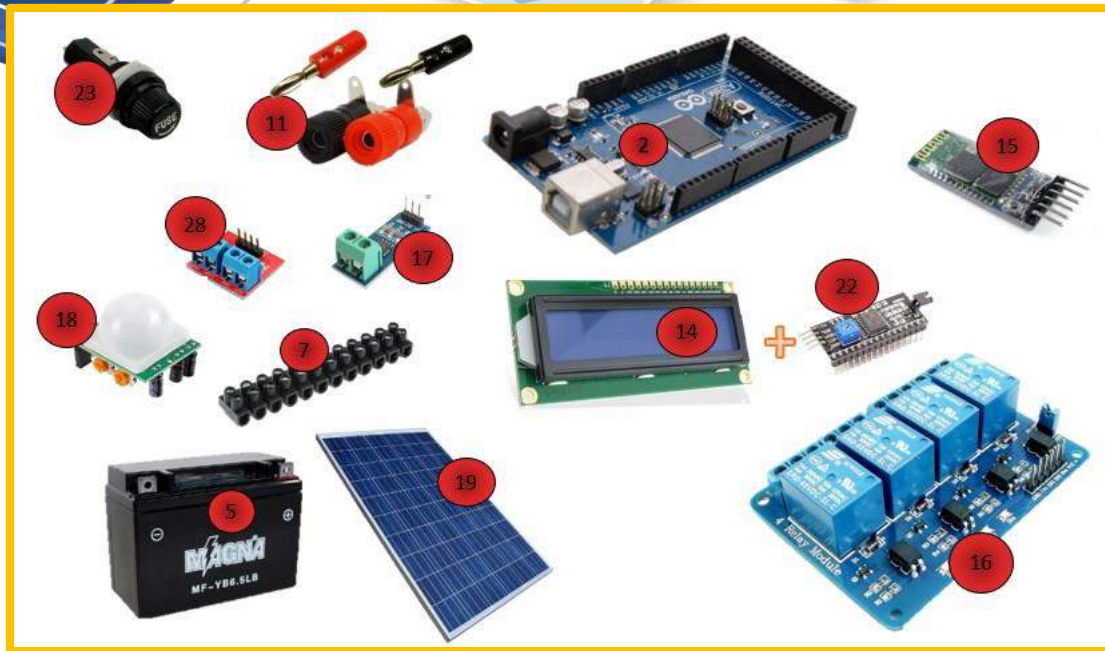
Figura 14. Elementos y componentes eléctricos para el montaje del Prototipo. Autoría Propia.
