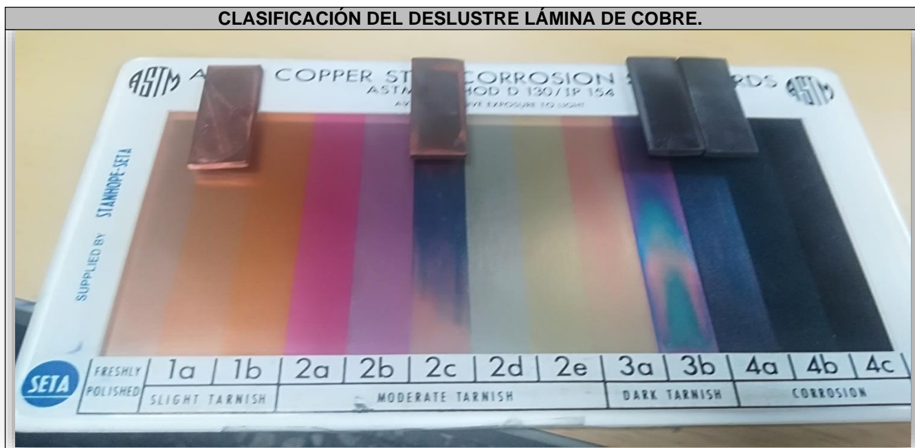
Fotografía 8. Resultados del deslustre corrosión lámina de cobre.
