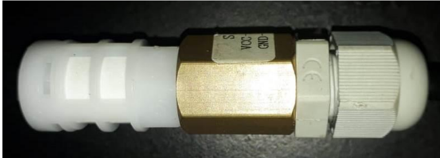
Fotografía 8. Sensor SHT10 con tapa plástica protectora
