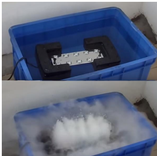
Figura 5. Nebulizador ultrasónico. Fuente: (Chaoyu Li, 2016)
