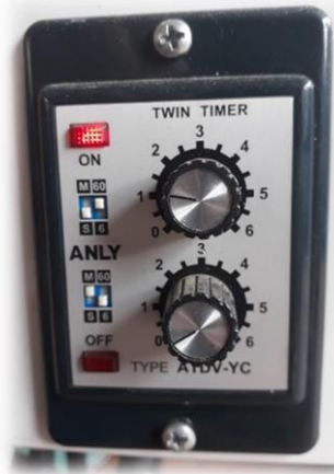
Fotografía 3. Timer análogo control de riego On/Off
