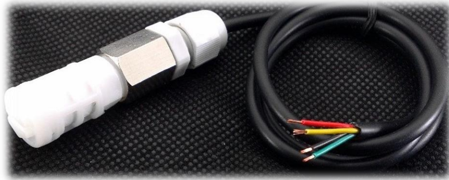
Figura 9. Sensor de Humedad y Temperatura Industrial SHT10. Recuperado de: didacticaselectronicas.com
