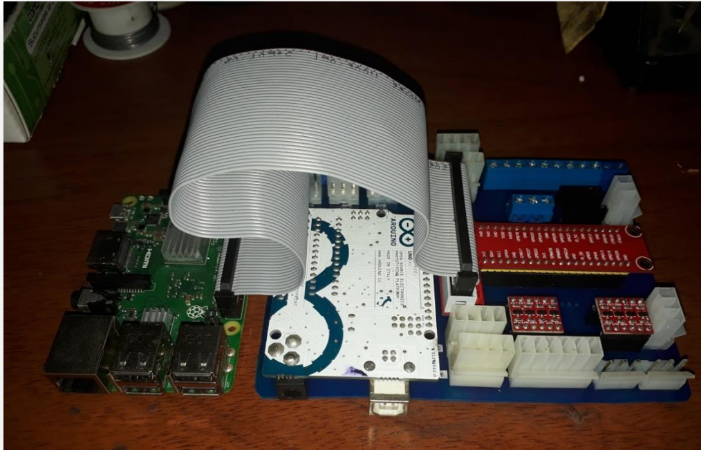
Fotografía 12. Conexión del Raspberry pi con la tarjeta de distribución y acople de los componentes.
