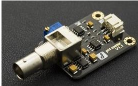
Figura 11. Gravity: Kit analógico de pH / sensor de pH para Arduino (dfrobot.com. s.f.)
