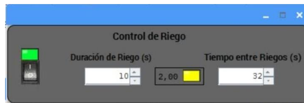
Figura 18. Interfaz gráfica del timer digital del control de riego
