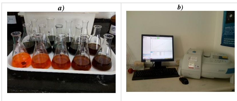
Figura 14. Determinación de Materia Orgánica. a) Estándares para la preparación de la curva de calibración; b) Espectro fotómetro usado. Elaboración Propia.
