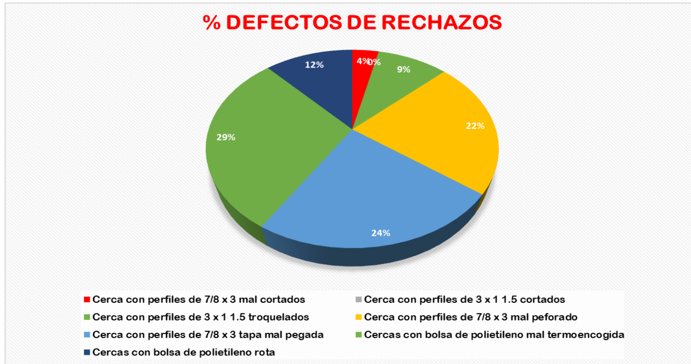
Figura 12. Gráfico del % de defectos de rechazos de cercas de 4x6 de la línea de retail de la empresa AZEMBLAS en 4 semanas antes del estudio.
