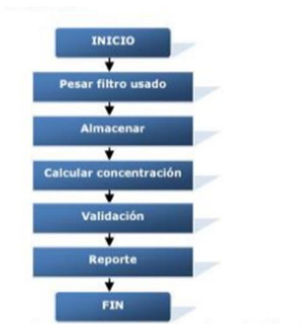
Figura 11 Diagrama de flujo de pos muestreo
