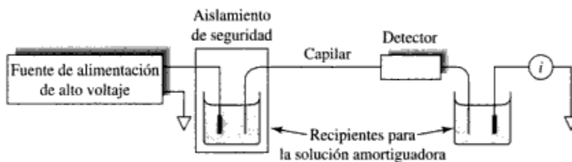
Figura 15. Esquema del equipo del Cromatografía de Electroforesis Capilar
