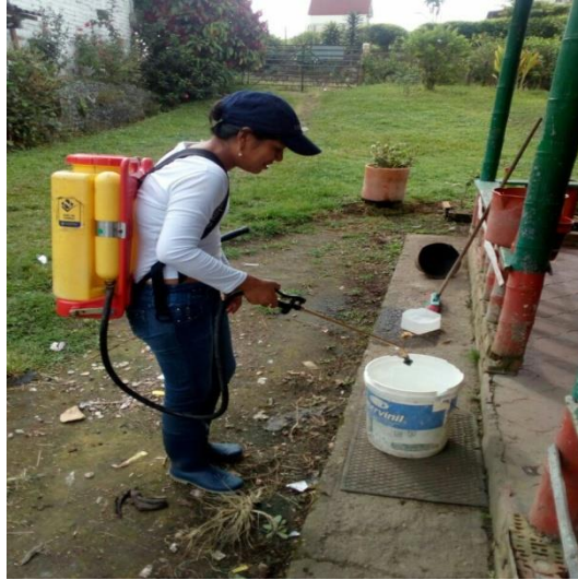
Fig. 20. Calibración de la maquina aspersora con boquilla de cono hueco Fuente: El Autor
