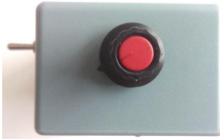
Figura 29C. Encapsulado del dispositivo detector de Obstáculos – parte superior.
