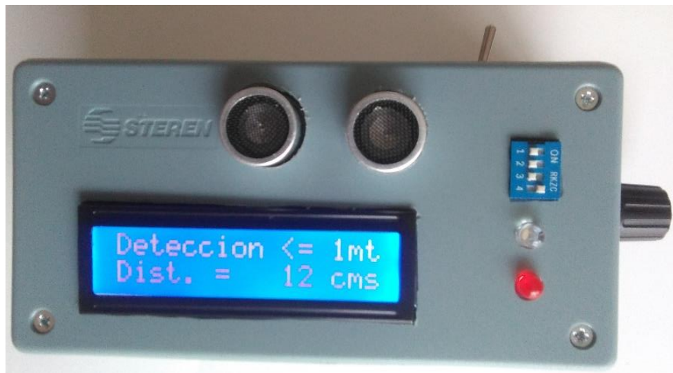
Figura 29A. Encapsulado del dispositivo detector de Obstáculos – Vista Frontal.
