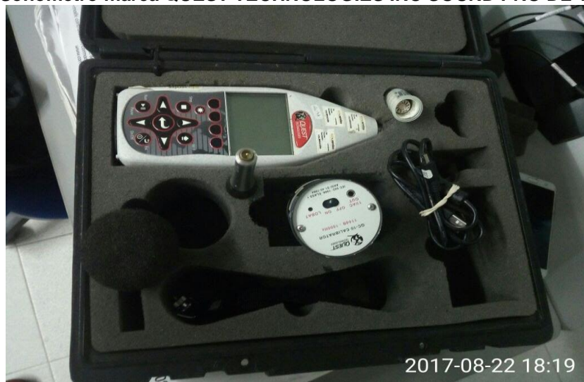
Foto 1. Sonómetro marca QUEST TECHNOLOGIES INC SOUND PRO DL 1-1/3 (3M)
