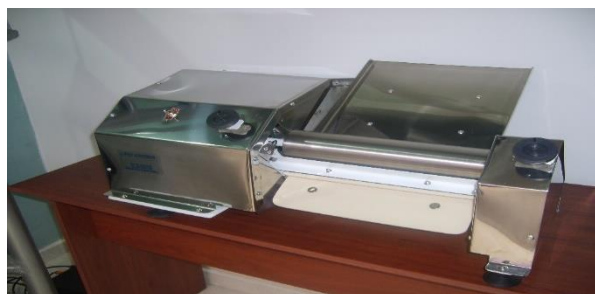
Figura N° 7. Laminadora eléctrica para masa de maíz. Fuente: http://www.imapan.com.co/
