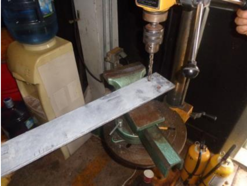
Fuente, registro fotográfico realización de agujeros con ayuda de taladro de árbol. Autor William Ortega Lubo.
