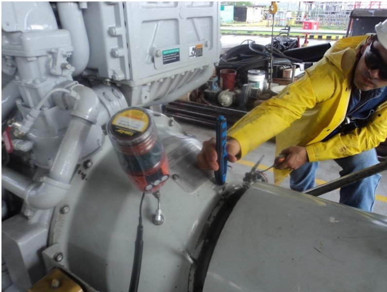
Figura 53, Registro de Toma de datos de vibración localizada sobre cojinete lado libre de embrague, actividad a cargo del operador del equipo y acompañada asistida por mantenimiento. Autor William Ortega Lubo.
