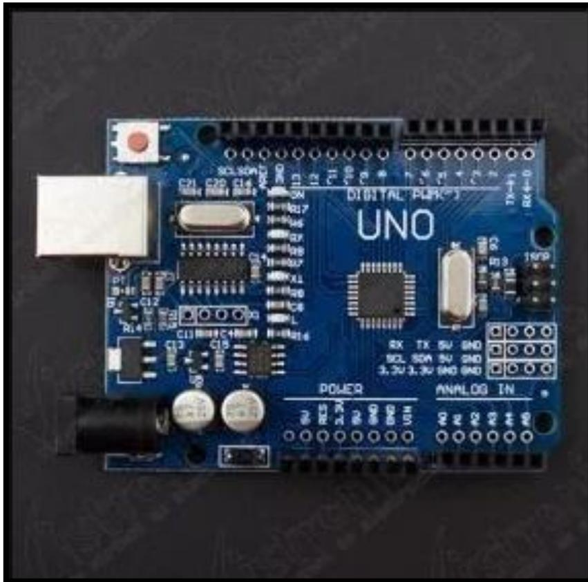
**Ilustración 1 Placa Arduino UNO R3**
