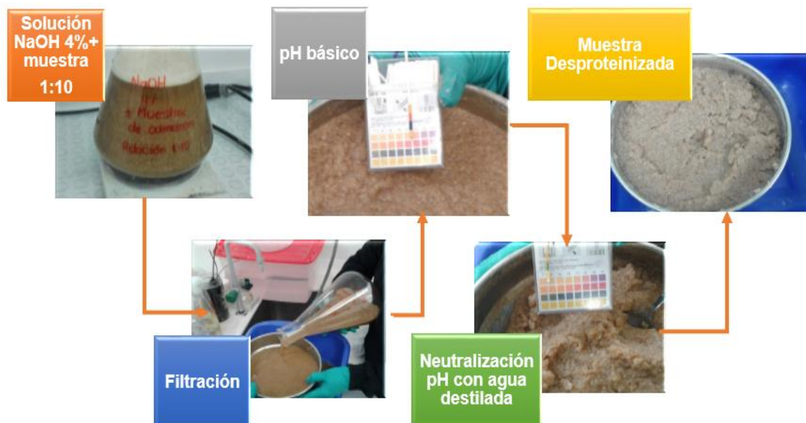
Figura 7. Desproteinización exoesqueletos de camarón
