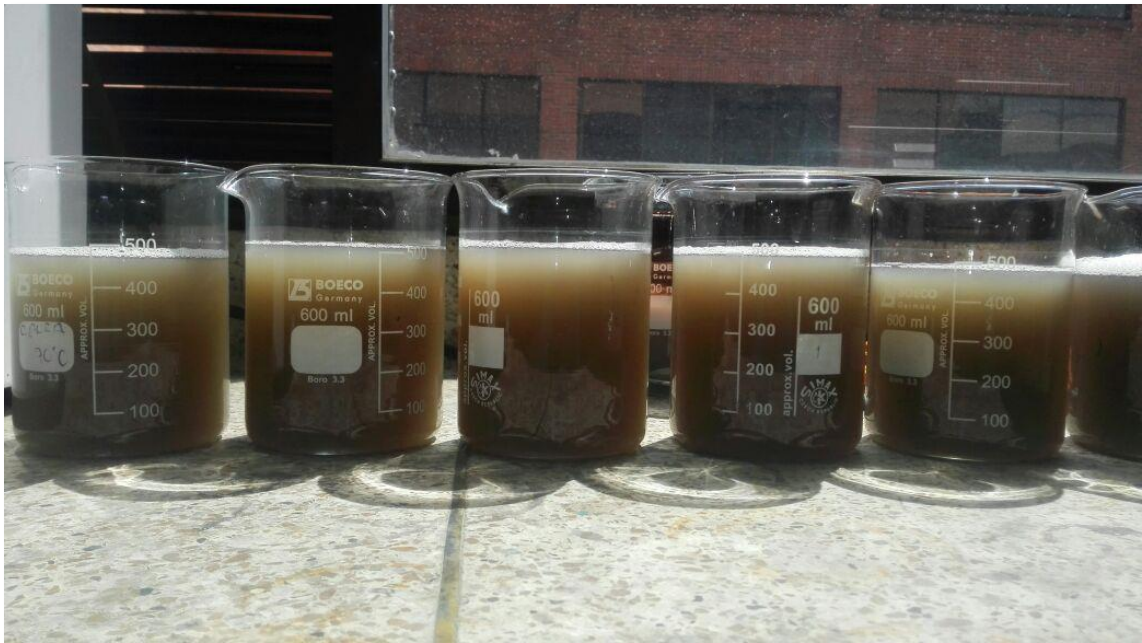
Figura 26. Test de jarras con mejores rendimientos en remoción de Turbiedad
