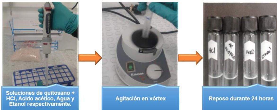
Figura 11. Prueba de Solubilidad del quitosano
