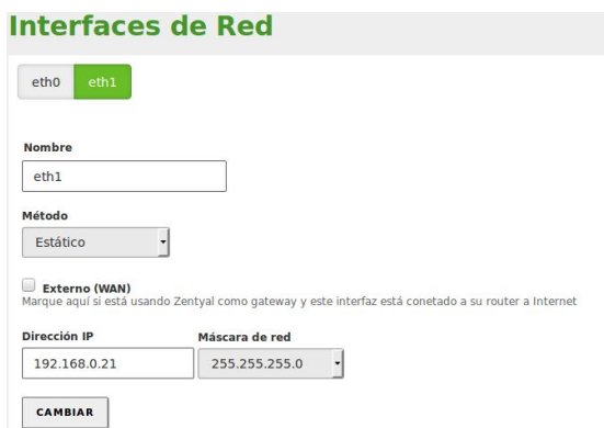
Fig. 2 Configuración interfaz de red eth1
