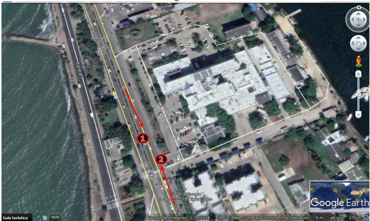
Figura No. 7. Movimientos vehiculares para la estación de la entrada del Hospital Naval de Bocagrande.
