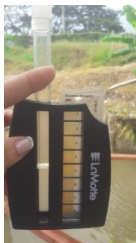
Ilustración 8 Control entrada agua a geomembrana Amonio
