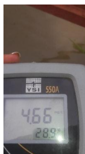
Ilustración 6 Control del agua entrada a Geomembrana OD, TEMPERATURA. Fuente. Autor
