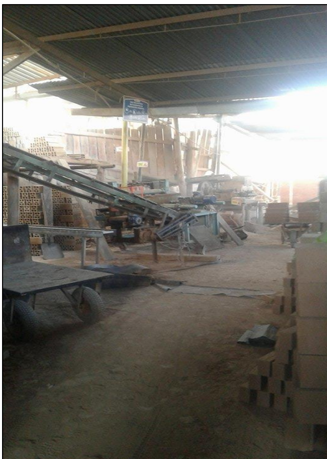
Ilustración 13. Banda Transportadora Proceso de Humectación Ladrillos el sol - Fuente: autor
