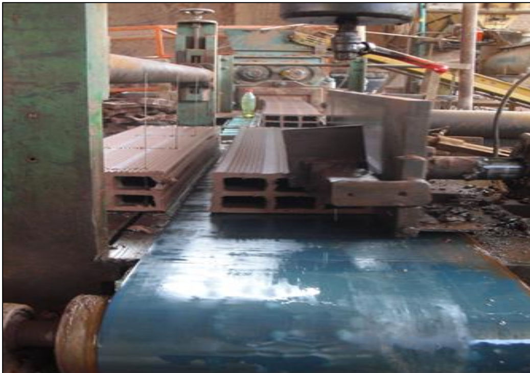
Ilustración 20. Maquina extrusora de corte y cargue del producto
