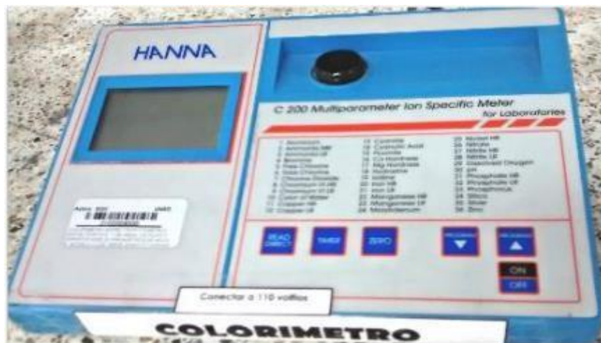
Ilustración 11 colorímetro de pilas marca hanna C-200 series
