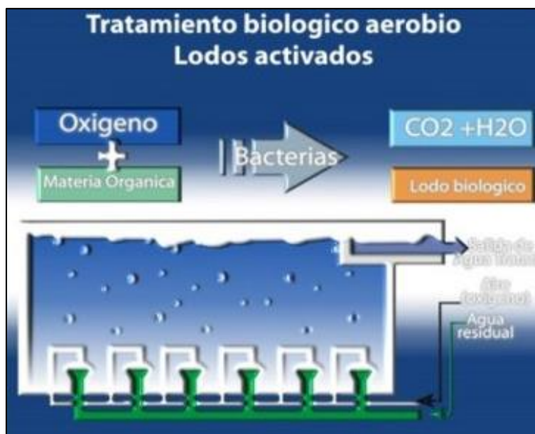
Figura 5. Procesos aerobios. Visualización de los procesos requeridos en el tratamiento biológico de lodos activados. Datos obtenidos de Biopur (2017,p.2)
