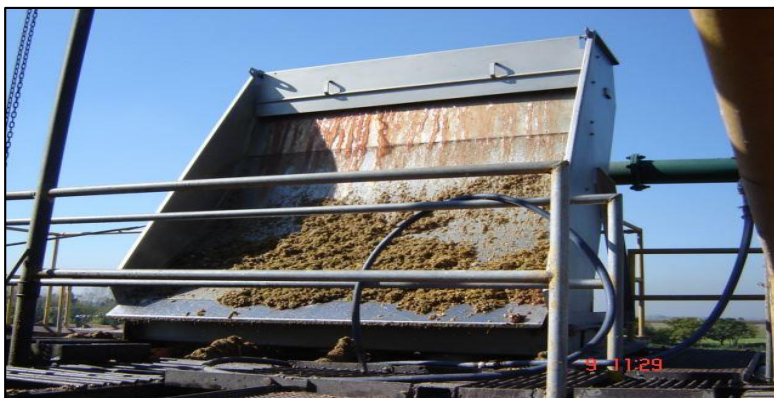
Figura 7. Tamices estáticos. Datos obtenidos de Nuevaferia (2017,p.1)
