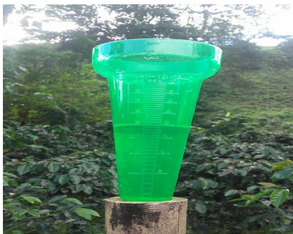
Figura 11, instalación del Pluviómetro
