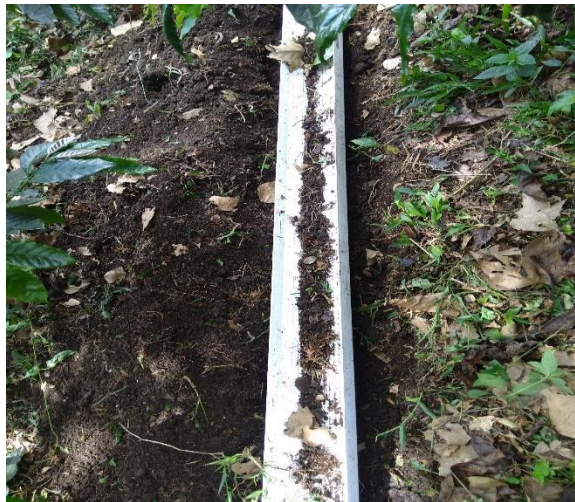
Figura 3, canales recolectores agua escorrentía
