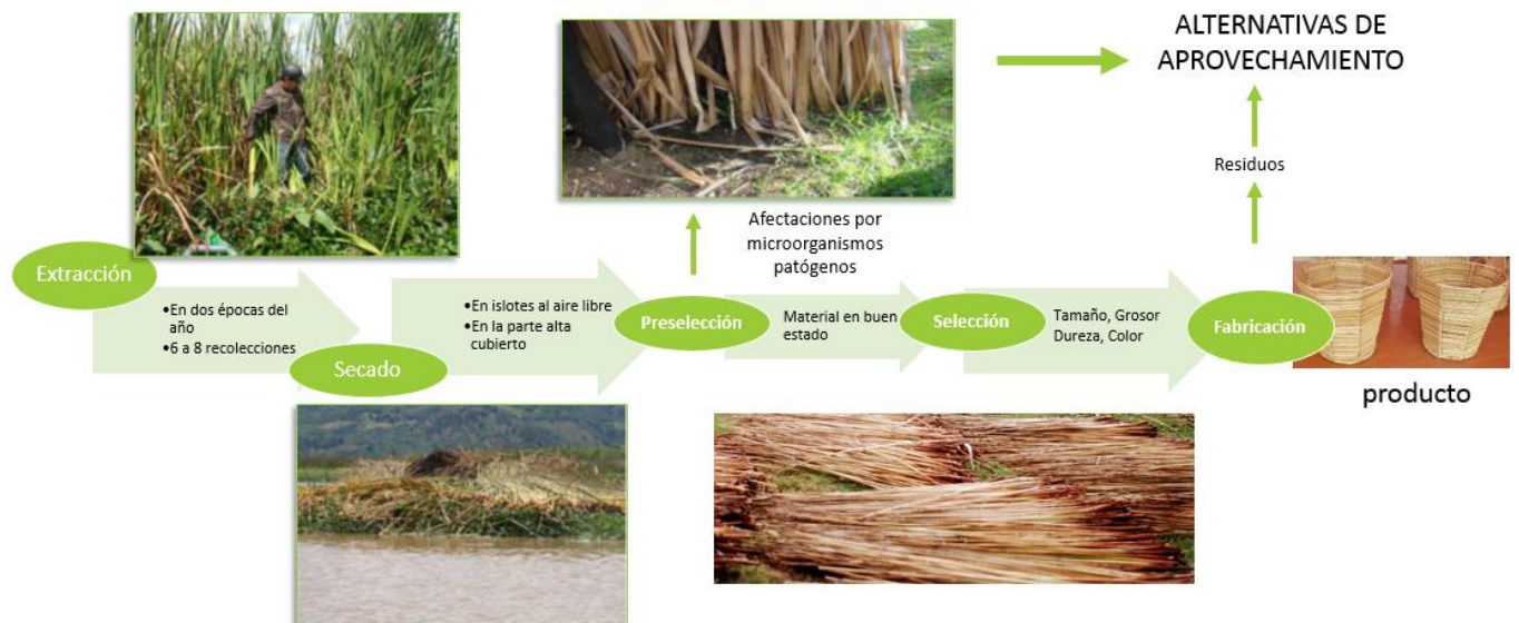
IMAGEN 9. DIAGRAMA DE PROCEDIMIENTO PARA LA ELABORACIÓN DE PRODUCTOS DE ARTESANÍAS A PARTIR DE JUNCO.
