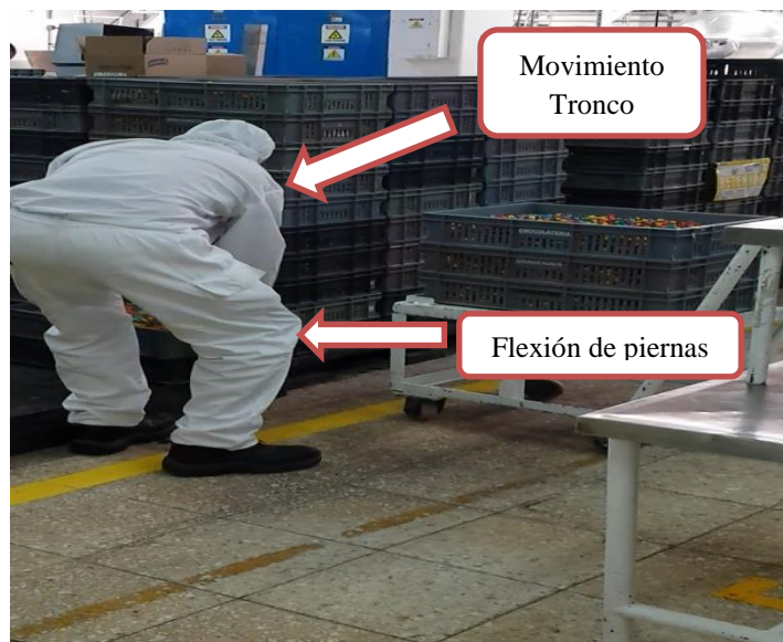
Figura 13. Paso 1 Para el proceso de Alimentación. Movimiento de tronco y flexión de piernas (Fuente: Empresa Colombina S.A)
