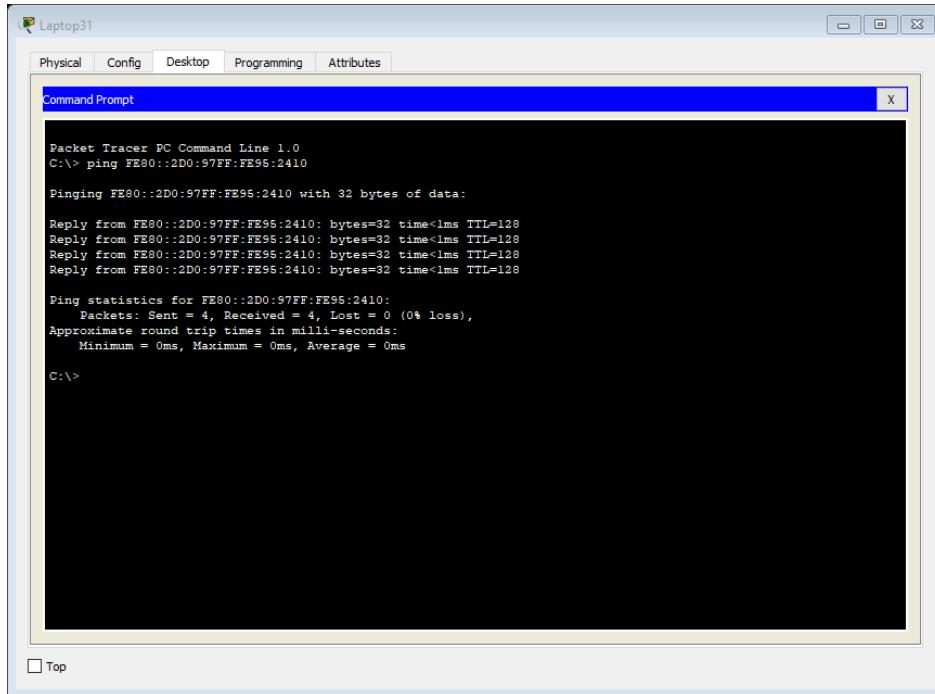
Al realizar el comando ping a los terminales pertenecientes a R3 se obtiene respuesta de las IP configuradas.
