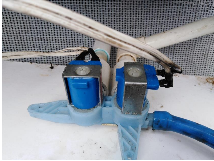
Figura 46. Electroválvula para fumigación (autoría propia)
