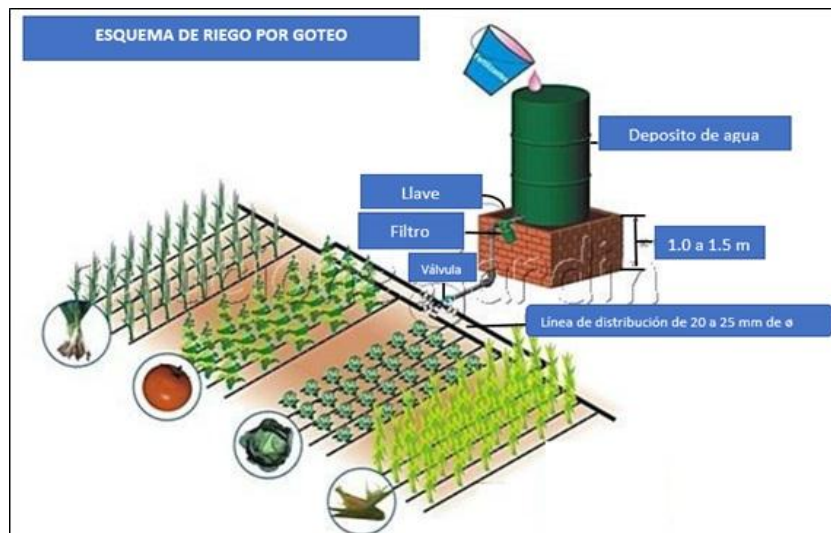
Imagen 22 Esquema de sistema de riego por goteo.
