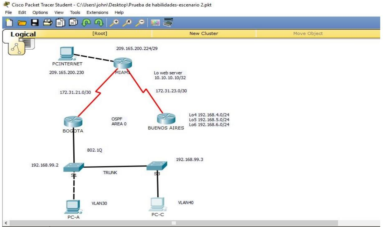
1. Configurar el direccionamiento IP acorde con la topología de red para cada uno de los dispositivos que forman parte del escenario
