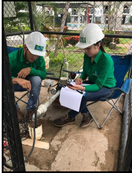
Fotografía 1. Medición de nivel dinámico con zonda piezométrica.
