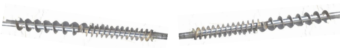
Figura 2 Fuente: Autor. Tornillos sin-fin de las dos tolvas, (cultivo establecido – soca) se muestra el tipo de rosca que debe llevar la abonadora en sus 4 salidas de fertilizante
