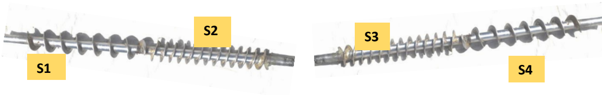
Figura 9 Fuente: Autor. Tornillos sin-fin de las dos tolvas, (cultivo establecido – soca) se muestra el tipo de rosca que debe llevar la abonadora en sus 4 salidas de fertilizante
