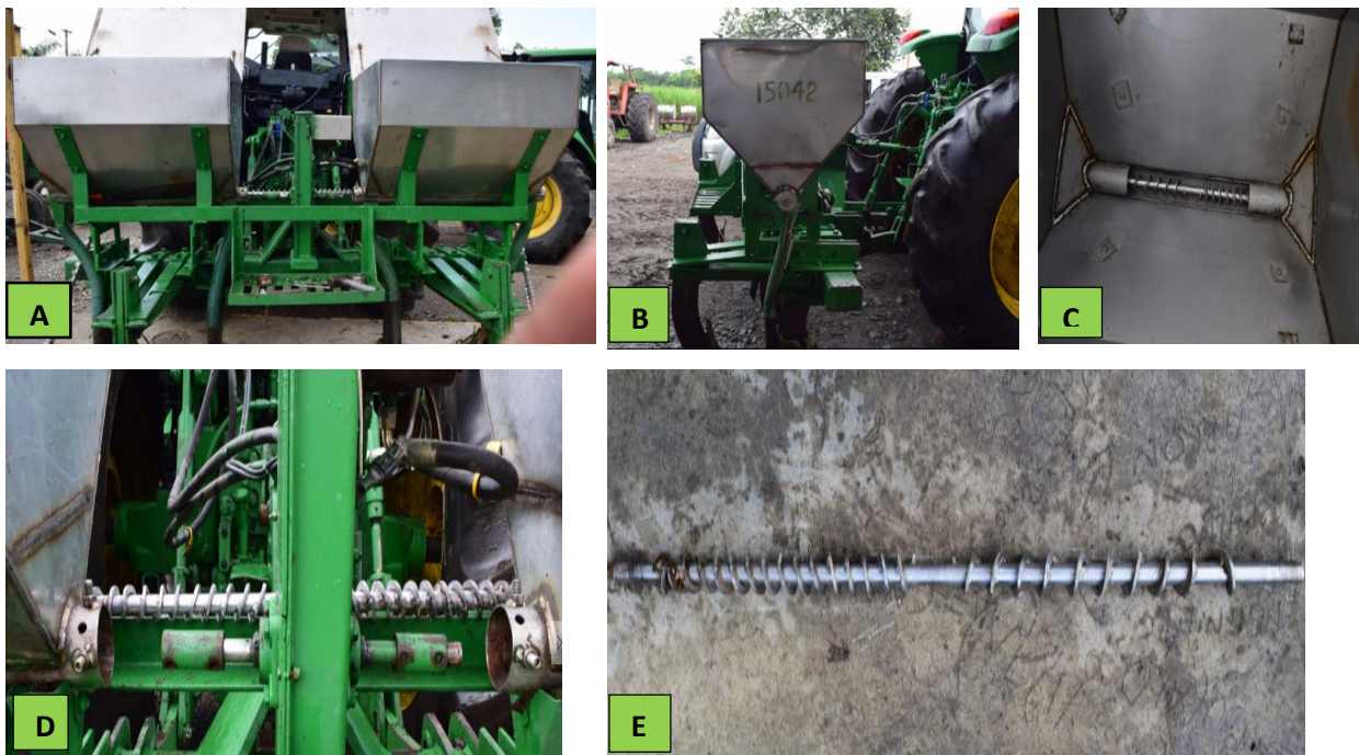
Figura 3 Fuente Autor. Abonadora marca Agro-equipos (figura 3A). Vista lateral de abonadora ((figura 3B). Vista superior del sin fin instalado en la tolva ((figura 3C). Vista del tornillo sin fin – enganche con la potencia del tractor
