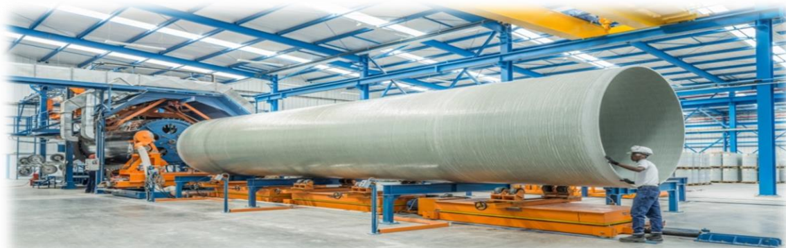
Ilustración 4 Inspección de tubería GRP
