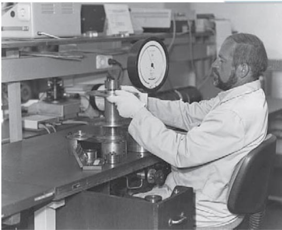
Figura 6. Calibración de un manómetro usando un peso muerto. (WIKA, 2008, pág. 259).
