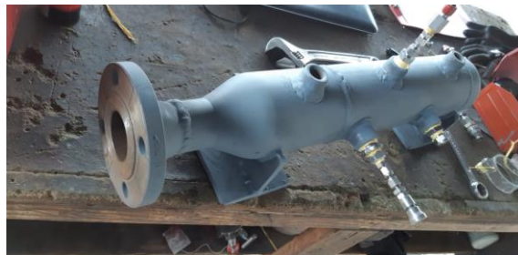
Figura 35. Construcción pulmón de aire, registro fotográfico cinco. Fuente: El autor.
