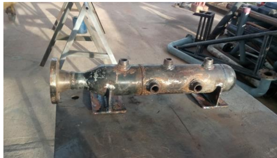
Figura 34. Construcción pulmón de aire, registro fotográfico cuatro. Fuente: El autor.
