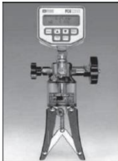
Figura 9. Calibrador portátil descrito por Creus. (Creus, 2010, pág. 649)
