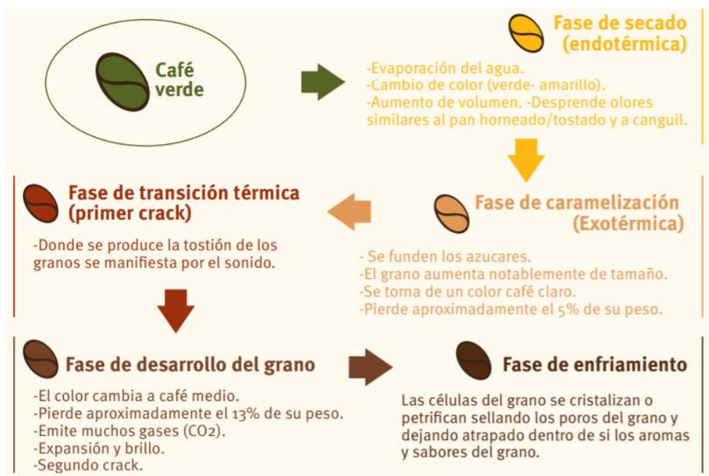
Figura 3 Principales fases del proceso de tostado. (Swisscontact/MIPRO © - Ministerio de Industrias y Productividad, 2016)
