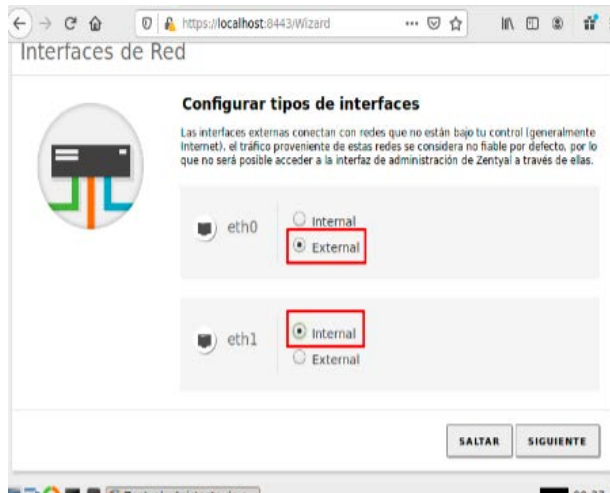
Figura 5. Tipos de interfaces de red.
